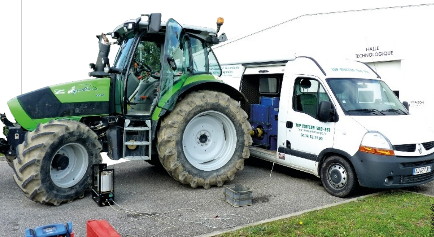
Dans le cadre du projet Optimoteur, ce sont 96 tracteurs qui sont passés au banc d'essai moteur.
