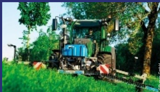
Avec une rampe articulée, le pulvérisateur Rumex RXF 600 est particulièrement adapté au travail dans les prairies.
