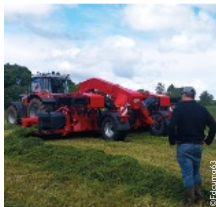
L'andaineur à tapis Sip Air HD 900 T de la cuma de Tortebeisse a une largeur de travail allant jusqu'à 9 m.
