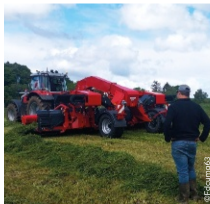
L'andaieur à tapis Sip Air HD 900 T de la cuma de Tortebeisse a une largeur de travail allant jusqu'à 9 m.
