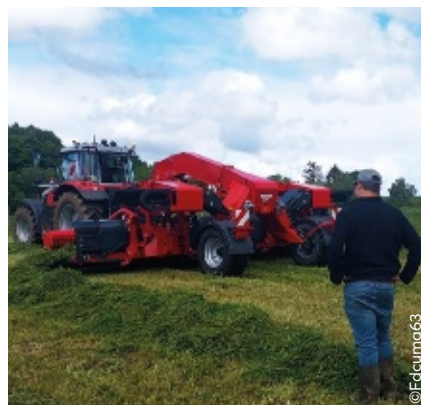
L'andaieur à tapis Sip Air HD 900 T de la cuma de Tortevesse a une largeur de travail allant jusqu'à 9 m.
