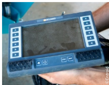
L'épandeur Rollmax 6325 est Isobus et ses fonctions peuvent s'afficher sur l'écran du tracteur. Pour les adhérents ne disposant pas d'un tracteur avec Isobus, un écran Rolland est aussi disponible.
