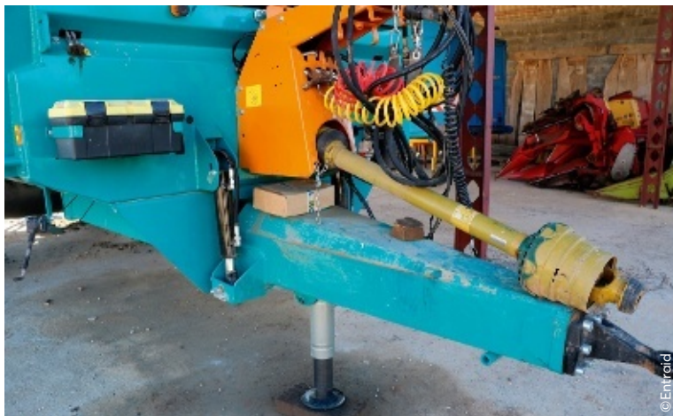
La flèche suspendue participe au confort. En revanche, la forme triangulaire fait que durant les manœuvres, les pneumatiques butent rapidement dessus, ce qui réduit le rayon de braquage.
