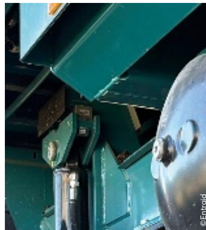
La pesée dynamique permet une mesure en temps réel du chargement. Des capteurs disposés sur l'essieu et la flèche permettent le contrôle de la dose épanchée à l'hectare en continu.
