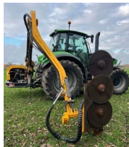
Pour les linéaires de haies, un entretien annuel peut être réalisé avec une épareuse.
