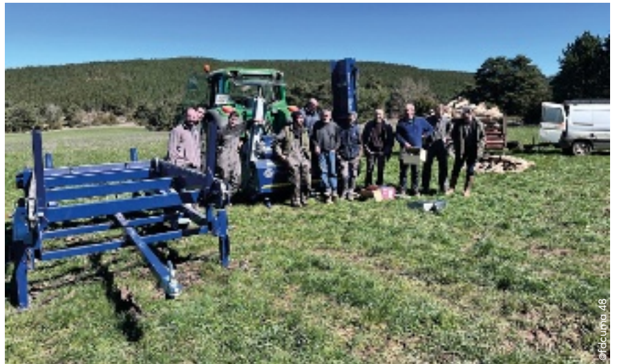
Du bois scié et fendu en un seul passage avec le combiné bois de la cuma la Dolanaise.
