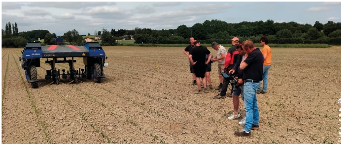
Cyclair met en avant une autonomie de 40 h pour son robot de désherbage en version hybride.
