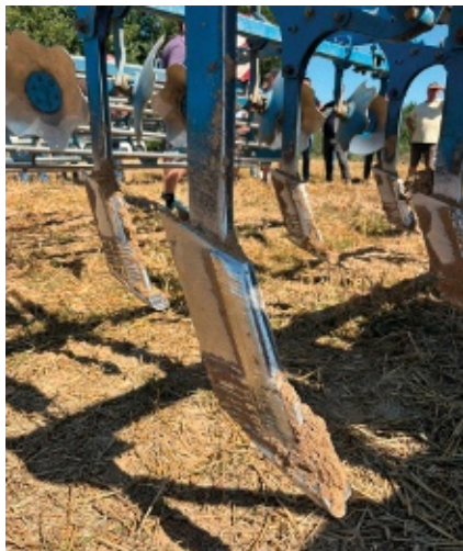
L'objectif de la fissuration est de casser la semelle de travail du sol sans que trop de terre fine descende en profondeur.
