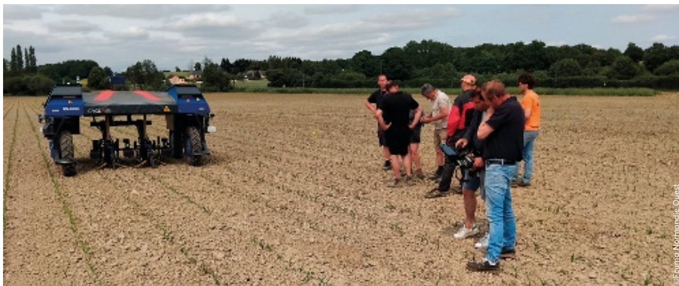
Cyclclair met en avant une autonomie de 40 h pour son robot de désherbage en version hybride.
