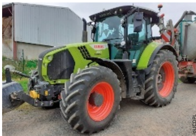
Tracteur Claas Camacuma de 185 ch de l'Orchidée, principalement utilisé par six exploitations pour des travaux de transports, travail du sol et en soutien pour l'activité presse enrurbaineuse.
