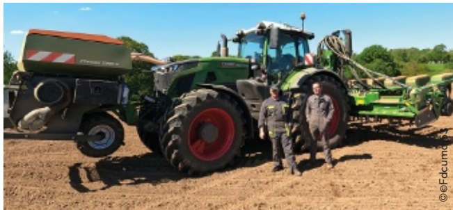
Le combiné de la cuma de Montaudin, en Mayenne, se compose d'une herse rotative, d'un semoir monograine 8 rangs et d'une trémie frontale.
