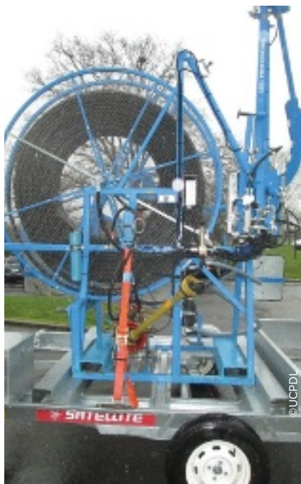
La cuma départementale Défis 85 propose son matériel de débouchage de drains sur une remorque pour voiture. C'est un atout qui facilite le déplacement entre les différents utilisateurs des cuma adhérentes.
