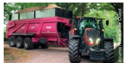
Les essieux arrière et avant sont suiveurs et forcés, ils limitent beaucoup le ripage de la remorque de 55m 3 .
