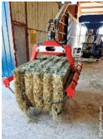
La presse à poste fixe forme des balles de foin de 100 cm de large, 80 cm de haut et 180 cm de long. Elles pèsent environ 400 kg.
