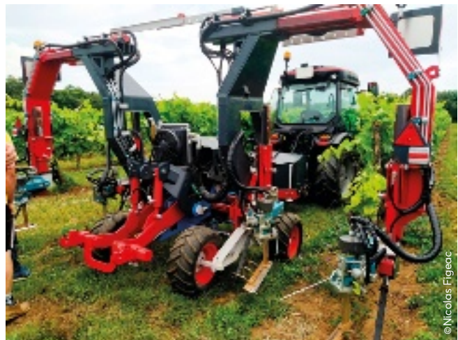
Les cuma de l'Ugni Blanc et de la Frenade ont acquis des outils de désherbage mécanique double rang.
