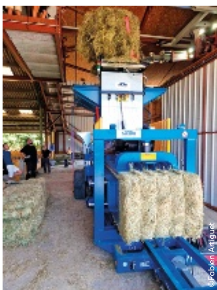
Les balles sont contenues par du fil de fer recyclable. Ce matériau permet un pressage du foin à haute densité.
