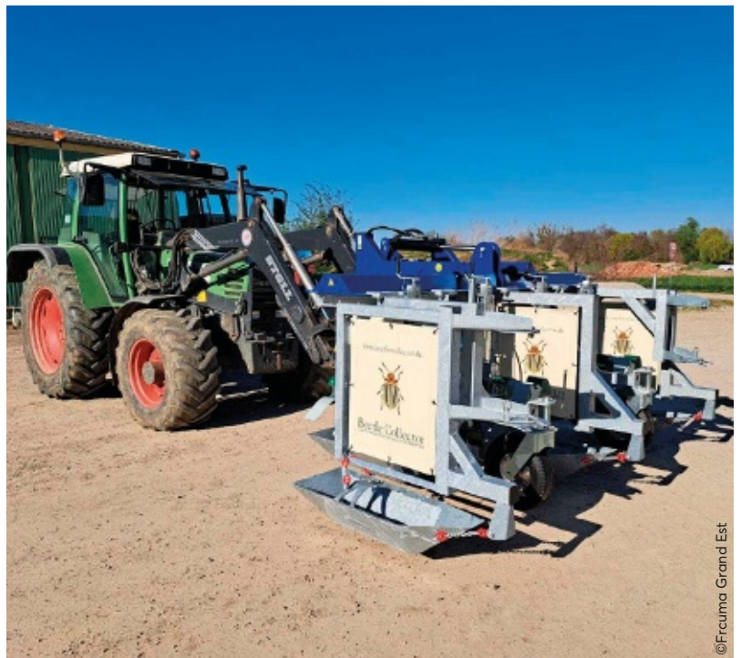
Chaque ligne de culture est équipée de deux rotors entraînés hydrauliquement tournant en sens opposés, ce qui améliore l'efficacité.
