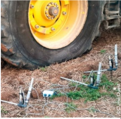
Les sondes indiquent la contrainte que chaque essieu applique au sol.
