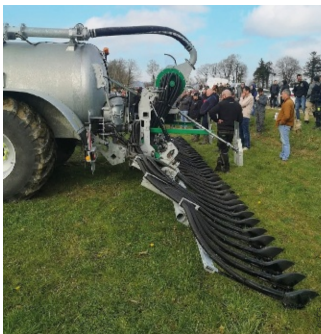
Le patin, ici une rampe 18 m sur une tonne Joskin, est pensé pour limiter au maximum le salissement des prairies. Il favorise un retour plus rapide des vaches au pâturage.
