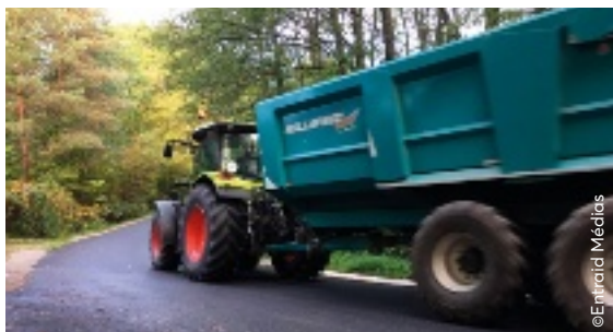
Les tracteurs avec un freinage double ligne dit smart ou intelligent peuvent freiner une remorque en simple ligne.
