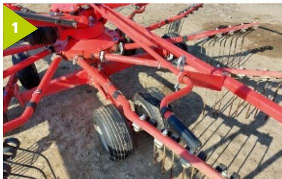
1. Le réglage de la hauteur de fanage se fait manuellement à la manivelle sur chaque rotor.
