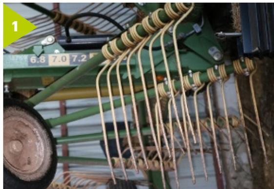
1. Appréciee des utilisateurs, la dent Lift est à l'aise dans le fourrage sec et humide.
