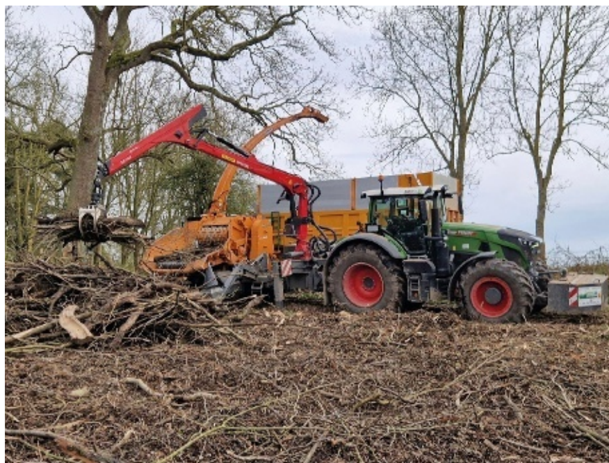
Un changement se situe au niveau des flexibles de l'ensemble de déchiquetage de la cuma spécialiste de la valorisation du bocage. L'huile qui y circule est désormais biodégradable.
