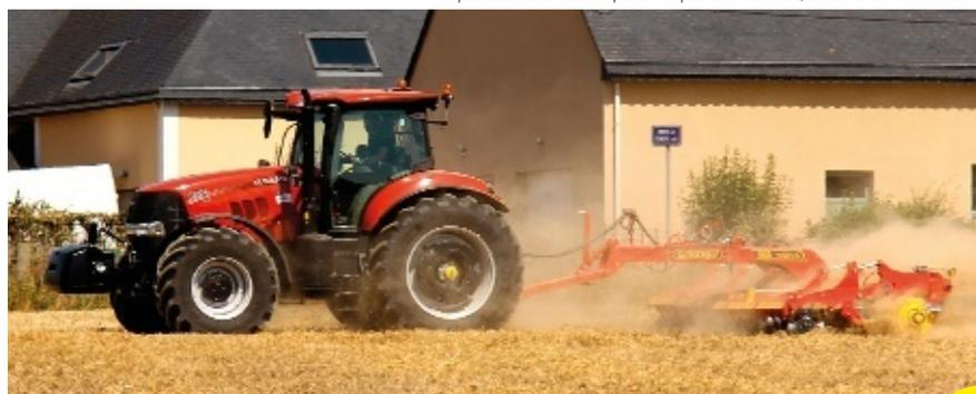
une largeur de travail de 4,5 m n'était pas suffisante pour valoriser sa capacité de traction. Autrement dit, le combiné porté n'aura valorisé que la capacité de ce tracteur à le porter lors des phases de déplacement.
