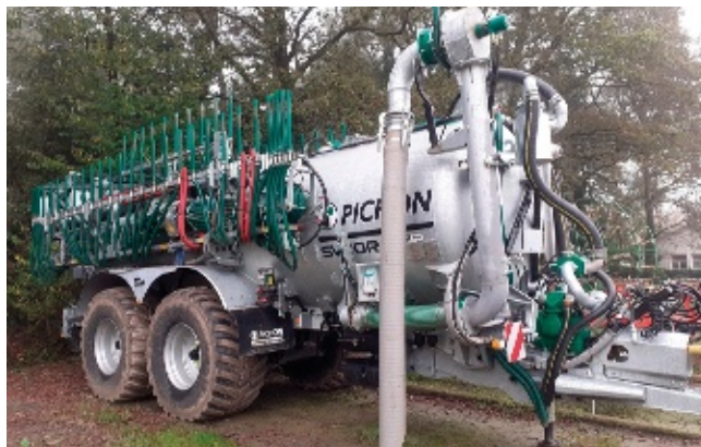
La cuma de la Roche s'équipe d'une tonne à lisier Pichon SV 20R de 21 000 l.
