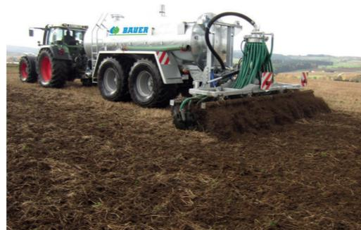
Puissance de pompage de 4 000 litres par minute à 6 bars de pression - des débits de 6 000 ou 8 000 l/min sont également disponibles en option. Un système de freinage à air comprimé à deux circuits avec régulation automatique de la force de freinage en fonction de la charge (ALB) est monté en série sur toutes les citernes polyester.
