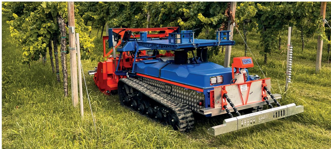
La machine fonctionne sans aucune surveillance et n'utilise aucun système GNSS/GPS. Le nouveau système innovant TeroAir offre un guidage de précision lié à une application de téléphonie mobile.
