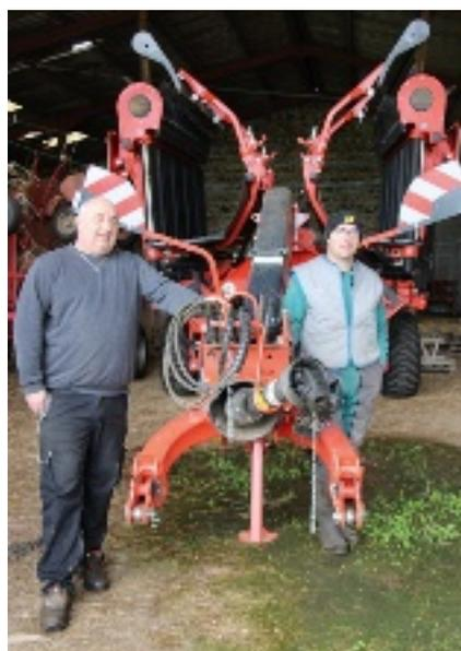
L'andaineur à tapis, un type de matériel capable de manier en douceur les fourrages fragiles, susceptibles d'être dégradés en cas de fanage ou d'andainage trop brusques.
