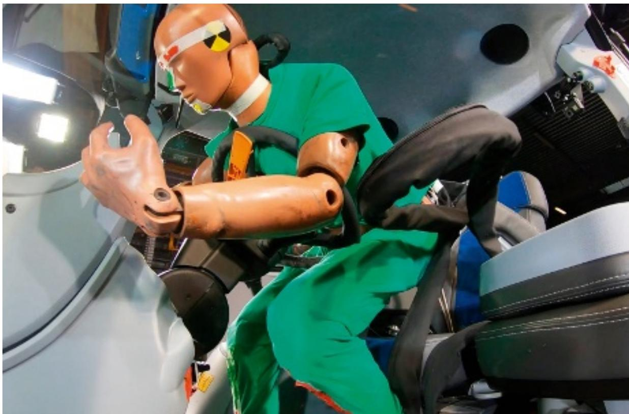
La rédaction d'Entraid et la MSA ont réalisé une simulation d'accident de tracteur, avec ou sans ceinture de sécurité. Les conséquences sont très importantes.
