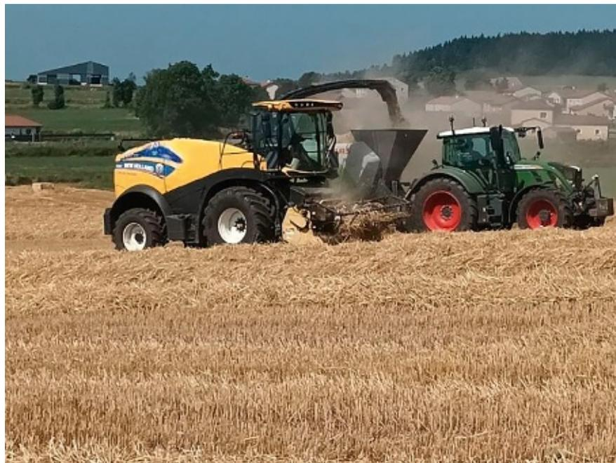
le bluetooth. Grâce à cela, les chauffeurs peuvent se parler en continu. La longueur des brins, entre 3 et 7 cm, est pilotée directement depuis la cabine. Les bottes réalisées pèsent entre 390 et 480 kg pour un débit de chantier souvent divisé par deux par rapport à un pressage classique.
