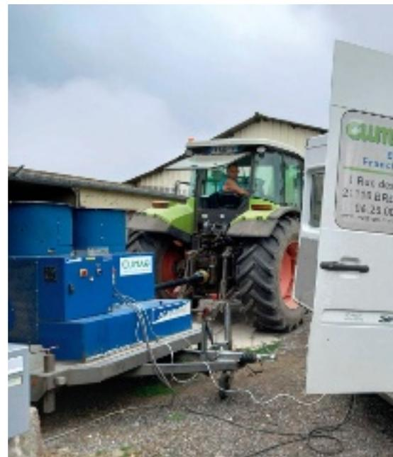
Le banc d'essai de la fruma AuRA se prépare à repartir sur les routes dès le début de l'année prochaine. Pour cela, la partie mécanique est révisée et l'inventaire concernant les différents raccords et outillage nécessaires pour travailler avec toutes les marques de tracteur est réalisé. La nouvelle version du logiciel du banc d'essai a été mise à jour ainsi que le calibrage des appareils de mesure.
