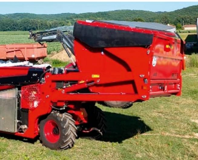
Avec près de 7 t à la pesée et un débit de chantier pouvant aller jusqu'à 1,35 ha/h, l'engin impose aussi par son gabarit de près de 8 m de long par 2,4 m de large.
