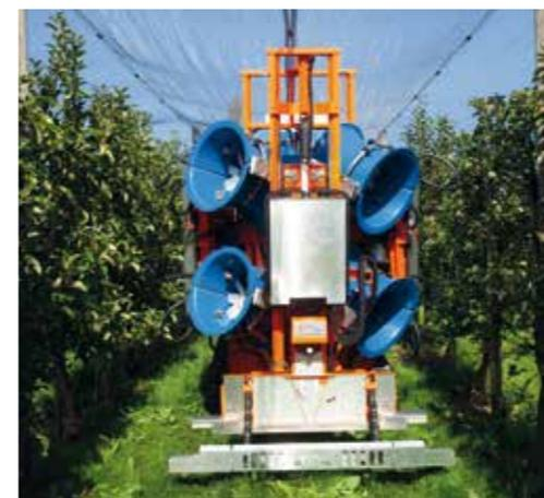
La machine utilise un bloc d'alimentation 48V avec une autonomie de 12 à 14 heures et un temps de charge de 8 heures. Doté de chenilles puissantes, il est très polyvalent et peut fonctionner dans des pentes de 42 degrés.
