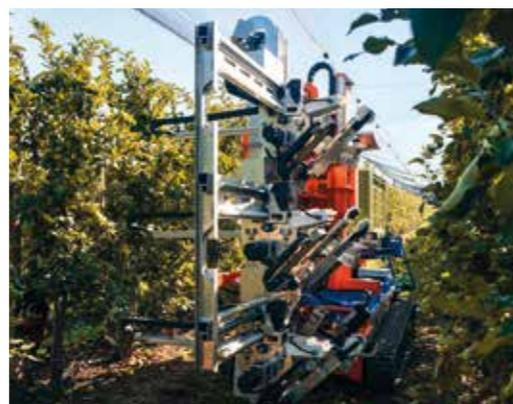
La machine fonctionne sans aucune surveillance et n'utilise aucun système GNSS/GPS. Le nouveau système innovant TeroAir offre un guidage de précision lié à une application de téléphonie mobile.
