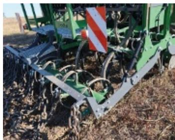
Facile à utiliser, cette machine se caractérise par son efficacité et possède une bonne capacité à pénétrer dans le sol, grâce à sa dent en "T inversé". De plus, la sélection de la graine se faisant par un disque en mousse adaptable à chaque taille de graine, il est possible
