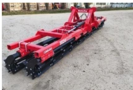
Techmagri lance un nouveau rouleau hacheur de couverts végétaux. Il est parti d'unités de 2 mètres de longueur, d'un diamètre de 42 cm à l'avant avec 8 lames et 35 cm à l'arrière avec 7 lames.
