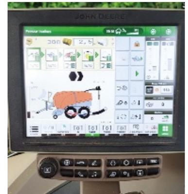
aussi une fonction valorisée pour la fauche grande largeur. Une fois programmé, en bout de champ il suffit d'appuyer sur un bouton et la vitesse du tracteur se réduit, la faucheuse frontale se lève, le régime chute. Puis c'est au tour de celle arrière, et les opérations se font inversement quand on a fini le demi-tour.
