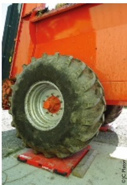
La pesée permet de déterminer la charge par pneu et la pression nécessaire au champ et sur route.
