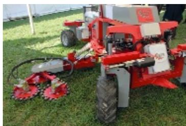
Léger a installé sa dédrageonneuse de noisetiers sur un prototype de porteur autonome. ■
