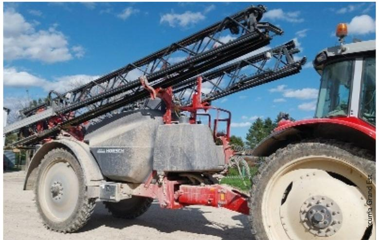
été difficile, il faut l'avouer. Grâce à ce fonctionnement de partage collectif, la cuma s'est permis d'ajouter des options comme la flèche suiveuse assistée hydrauliquement, notamment. Ce système permet le suivi parfait des traces du tracteur grâce au contrôle hydraulique et au maintien souple de la rampe. Le pulvérisateur a ainsi une plus grande maniabilité et un angle de
