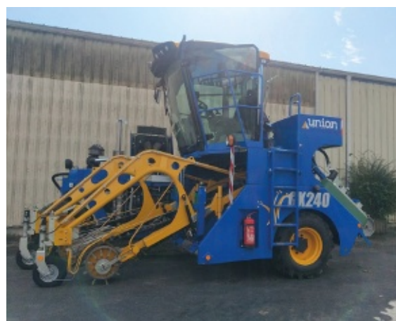
Retourneuse automotrice de lin sur le site de Commana.
