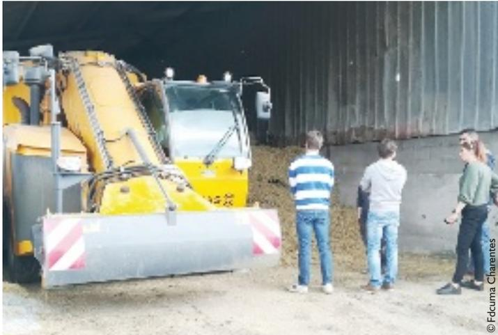
La mélangeuse-automotrice de la cuma apporte un gain de temps de 2h/j, pour un coût d'utilisation de 3€/min.
