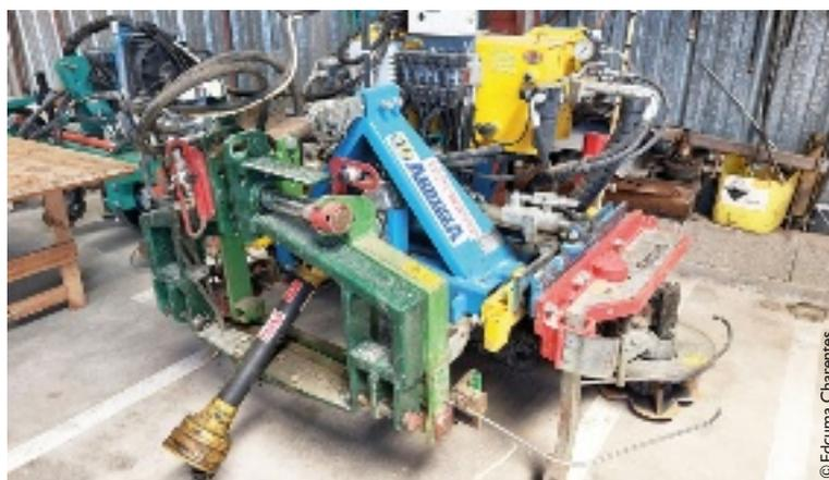
Interceps polyvalent de 2011, équipé d'un cadre de guidage converti avec un équipement de débattage permanent.
