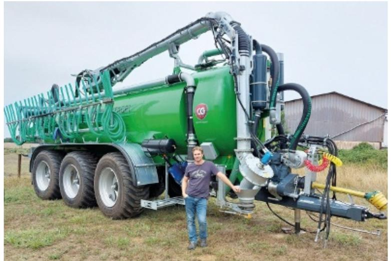
Avec la rampe, les effluents sont déposés au plus près du sol. Cela atténue fortement les nuisances visuelles et olfactives pour les riverains. La rampe apporte également une régularité de la répartition grâce à la largeur de travail fixe et au faible écartement des tuyaux. Il est donc possible de passer dans les cultures en croissance, en valorisant ainsi un apport de matière organique issu de la ferme ou de la méthanisation.
