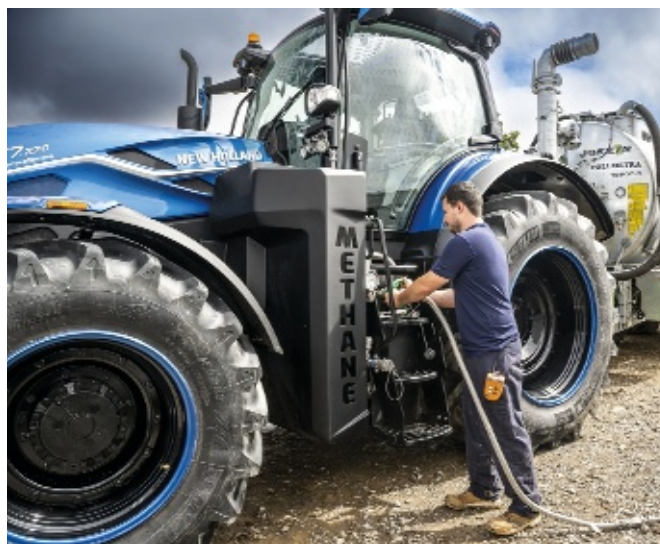
Le T7 de 270 ch fonctionnant au méthane s'annonce pour 2025, avec l'argument de l'autonomie grâce au gaz liquéfié.
