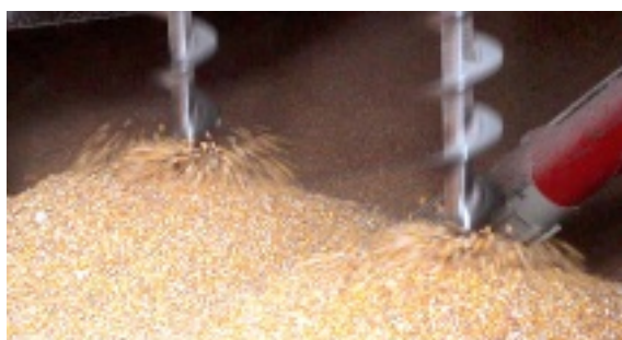
Dans la cellule, le grain est remonté en permanence.
