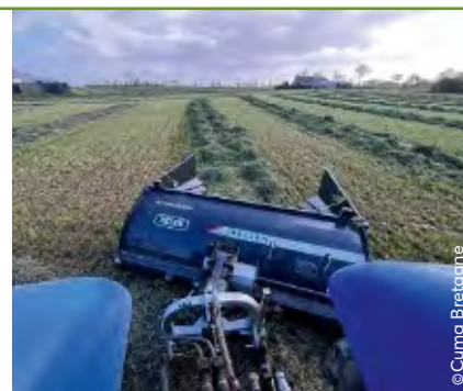
Le retourneur d'andain travaille sur 2,75 m de largeur.
