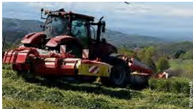
La cuma de Saint-Médard-Nicourby a fait modifier son combiné de fauche Pöttinger pour obtenir un andain de la dimension du pick-up de l'ensileuse.
